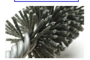
シリコンカーバイト(炭化ケイ素)入ナイロントレグリットM(東レ社)を使用した工業用ブラシです。酸化アルミナに比べ砥粒が硬く鋭く、従来品に比べ砥粒の硬度が高い為、硬質金属類に力を発揮します。ブラシ外径Φ6mmからΦ20mmまでをラインナップしており、すべてのサイズをW/S式でねじり上げている為、毛量を多く保持し、毛材表面密度が均一に仕上がっております。様々な円筒内部のバリ取りや研磨作業に対応するように、#240から#500までの毛材を使用しております。
