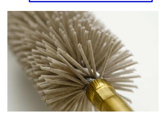
酸化アルミナ入ナイロンを使用した工業用ブラシです。シリコンカーバイトに比べ砥粒の形状がソフトな為、軟質金属の仕上げ処理などに力を発揮します。ブラシ外径Φ6mmからΦ20mmまでをラインナップしており、すべてのサイズをW/S式でねじり上げている為、毛量を多く保持し、毛材表面密度が均一に仕上がっております。様々な円筒内部のバリ取りや研磨作業に対応するように、#240から#600までの毛材を使用しております。
