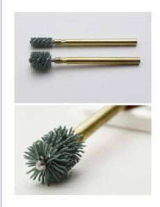
■シリコンカーバイト(炭化ケイ素) 入ナイロントレグリットM(東レ社)を使用した工業用ブラシです。酸化アルミナに比べ砥粒が硬く鋭く、従来品に比べ砥粒の硬度が高い為、硬質金属類に力を発揮します。ブラシ外径Φ6mmからΦ20mmまでをラインナップしており、すべてのサイズをW/S式でねじり上げている為、毛量を多く保持し、毛材表面密度が均一に仕上がっております。様々な円筒内部のバリ取りや研磨作業に対応するように、#240から#500までの毛材を使用しております。
